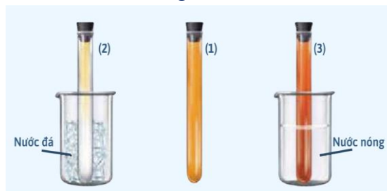
Hình 1.1. Ảnh hưởng của nhiệt độ đến chuyển dịch cân bằng 2\text{NO}_2 \rightleftharpoons \text{N}_2\text{O}_4
