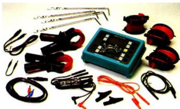
Hình 3. 8: Máy đo điện trở nối đất và điện trở suất của đất
